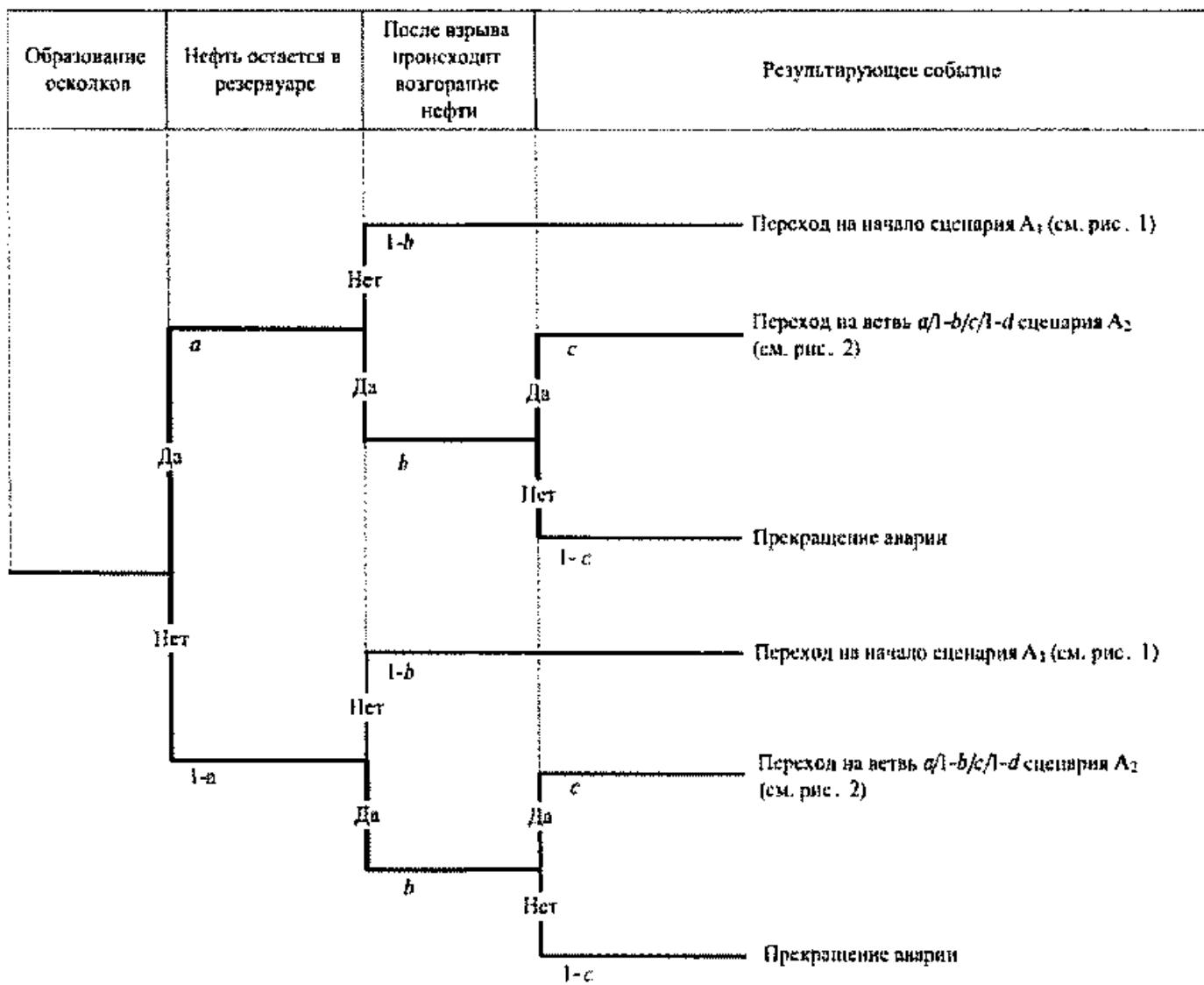
Рис. 3. "Дерево событий" при взрыве внутри наземного резервуара (сценарий А3)
