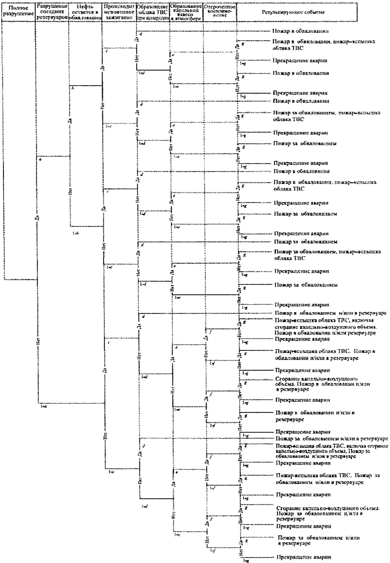
Рис. 1. "Дерево событий" разрушения/перелива наземного резервуара (сценарий А1)
