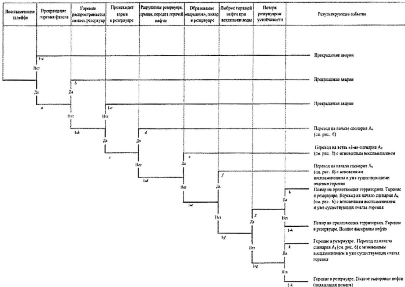
Рис. 2. "Дерево событий" при выходе газовой фазы с наземного резервуара (сценарий А2)
